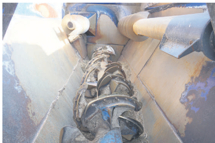
Dwunastometrowy DeLaval pracował w OHZ Gajewo przez dwanaście lat. Maszyna wyposażona jest w trzy bębny ślimakowe, z których jeden dolny pełni funkcję mieszająco-rozdrabniającego, natomiast pozostałe dwa to bębny mieszające. Sprzęt posiada własny, niezależny od ciągnika, układ hydrauliczny oraz tylny frez pobierający paszę z pryzmy
