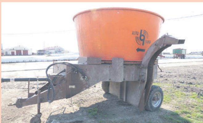
Dwunastometrowy DeLaval pracował w OHZ Gajewo przez dwanaście lat. Maszyna wyposażona jest w trzy bębny ślimakowe, z których jeden dolny pełni funkcję mieszająco-rozdrabniającego, natomiast pozostałe dwa to bębny mieszające. Sprzęt posiada własny, niezależny od ciągnika, układ hydrauliczny oraz tylny frez pobierający paszę z pryzmy
