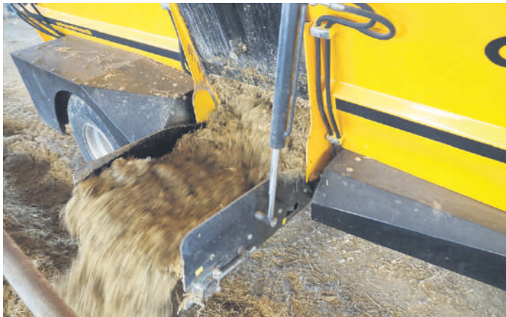
Wyładunek TMR-u następuje przez boczne okno z przenośnikiem taśmowym. Otwór wysypowy mierzy pół metra szerokości
